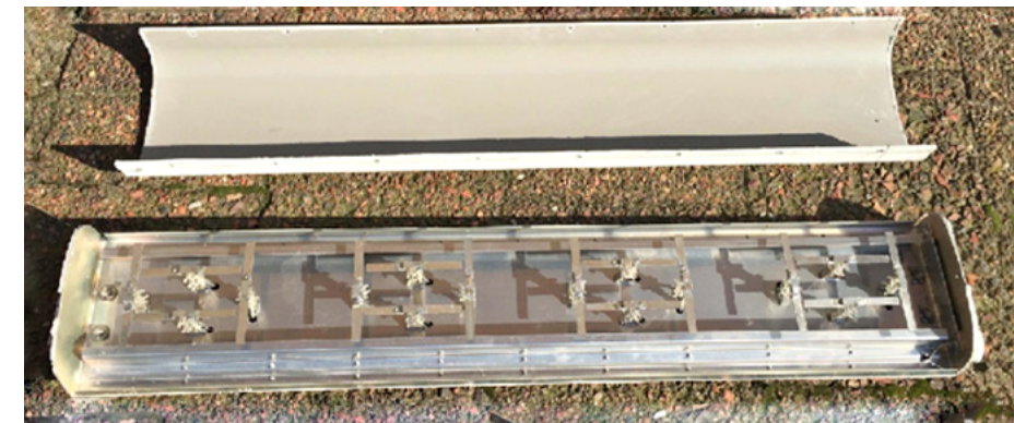
Rys. 10 Wnętrze typowej anteny sektorowej stosowanej w stacji bazowej telefonii komórkowej
